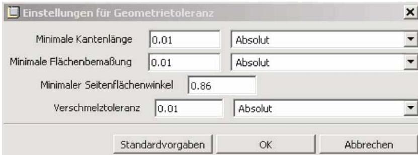
**Abb. 11-47: Toleranzeinstellungen für den automatischen Vernetzer AutoGEM**
