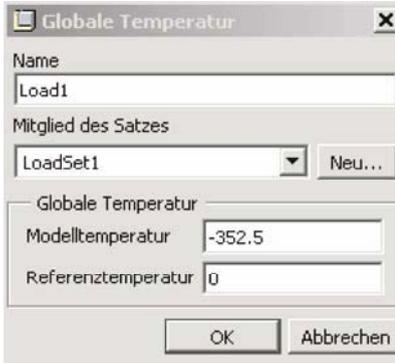
Abb. 11-52: Korrektur der Temperaturlast. Die erforderliche Temperaturdifferenz von 352,5 °C ergibt sich aus dem (nahezu) linearen Zusammenhang zwischen der Temperaturlast und der gemessenen Vorspannkraft der Schraube.
