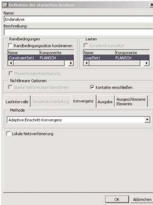
**Abb. 11-57: Definition der Endanalyse.** Die Vorspannkraft von 100 kN wird mit der Betriebslast Innendruck 100 bar überlagert. Im Allgemeinen sollte abschließend immer eine Mehrfachkonvergenzanalyse durchgeführt werden, sofern die Ressourcen dies erlauben.
