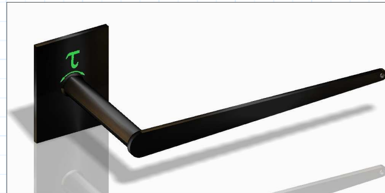
Abbildung 6: Torsionsspannung in einer geschweißten Kurbel
